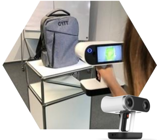
Einscannen von Objekten und erzeugen von CAD-Modellen
